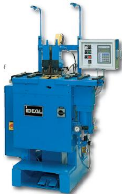
Модель BAS 100 с тиристорным устройством отжига и устройством контроля параметров
