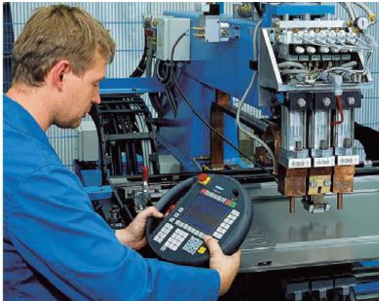
Модель CSR при сварке дверей серверных шкафов
