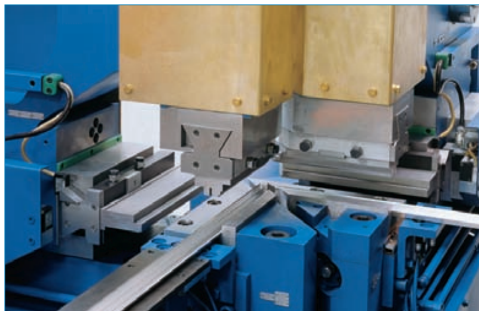
Gehrungsschweißung von Aluminium-Fassadenrahmen
