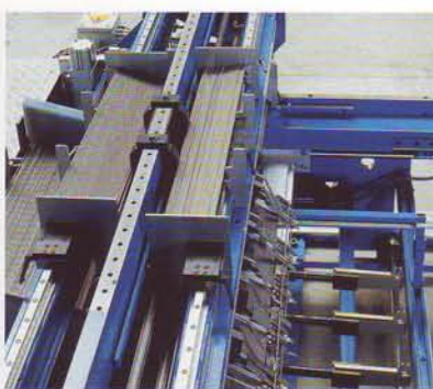
Dreifach-Querdrahtmagazin zur Ausgabe unterschiedlicher Querdrahtdurchmesser /-längen
