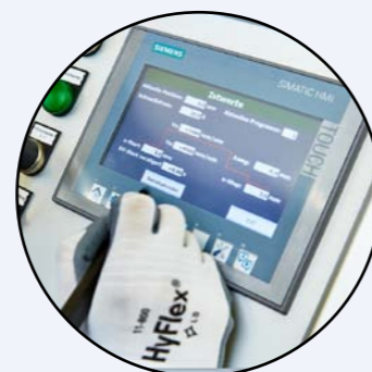
Modernes Bedienfeld Siemens KTP
