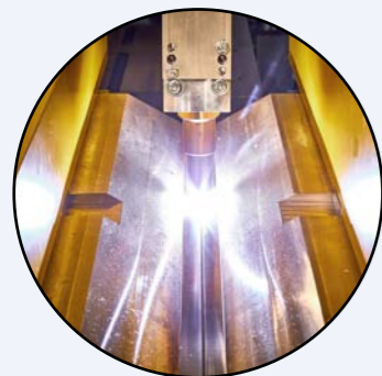
MAG-Schweißung auf Spanntisch
